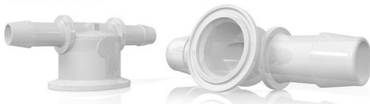
**SFシリーズ**はチューブをサニタリーヘルールに取り付けるためのアダプターです。ASME-BPE規格の3/4”用と1.5”用があります。素材はそれぞれポリプロピレン(6005)とPVDF(J2A)がございます。また、ヘルールキャップもございます。ポリエチレン製のヘルールチューブティー(及びミニ)はガスケットにシリコン製のゲージガードガスケットを使用するとダイヤフラム式圧力計が接液させることなくシングルユースのラインに使用できます。
